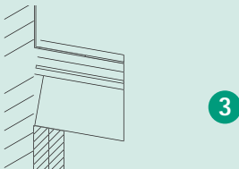
Detail 3 Aansluiting op opgaande muur ter plaatse van het roede-profiel. Over de gezette lijst (onderdeel 6050 waanaansluitlijst) kan een loodslab aangebracht worden (zelfdragend systeem)
